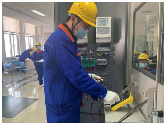
图 7-9 电能计量装置接线分析培训
